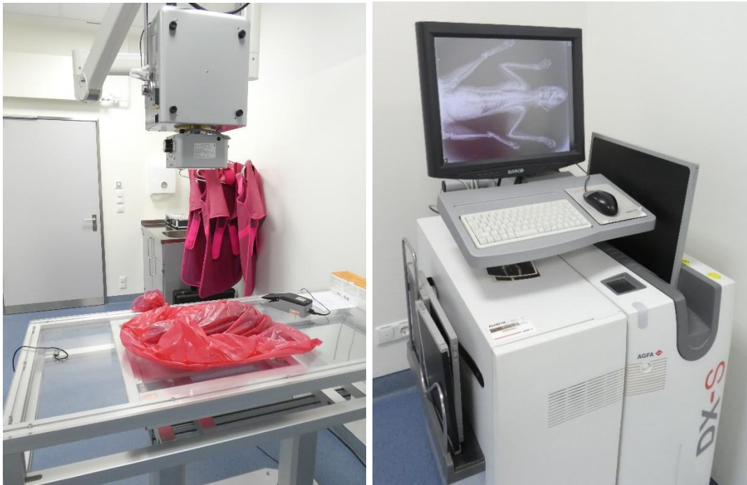
Abbildung 2: Röntgenröhre mit einer in einen roten Plastikbeutel verpackten Wildkatze auf der Röntgenplatte (links) und Röntgenbildentwickler (rechts) an der KVRAF, JLU Gießen
